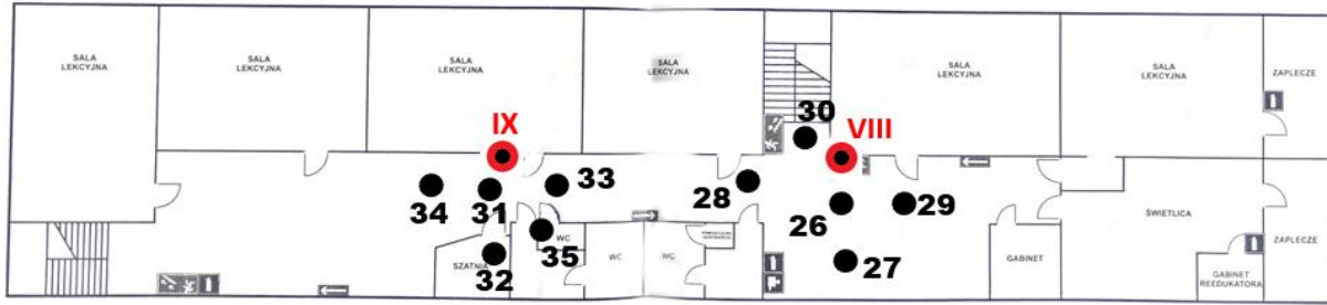
Rys. 1c: Plan rozmieszczenia punktów pomiarowych – II piętro (stare skrzydło), kolorem czerwonym oznaczono lokalizację punktów dostępowych
